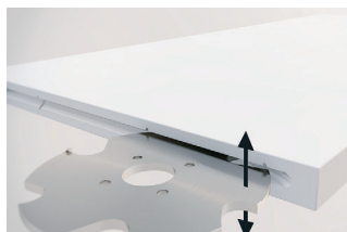
Mill P-system groove
